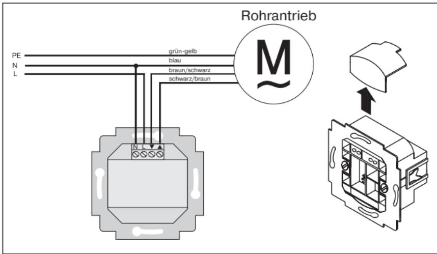
2. Setzen Sie die Schutzkappe wieder auf das Netzteil.
