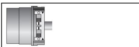
Schieben Sie den Schalter der zugehörigen Endlage von der Programmier-Stellung in die Lösch-Stellung.
