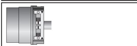
Schieben Sie den Schalter der Ausfahr-Drehrichtung von der Lösch-Stellung in die Programmier-Stellung.
